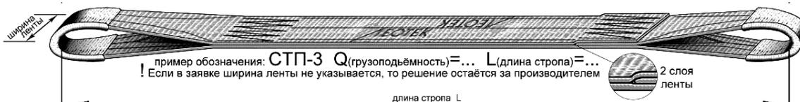
**Ремень стяжной производства фирмы «INKA» (Финляндия)**
